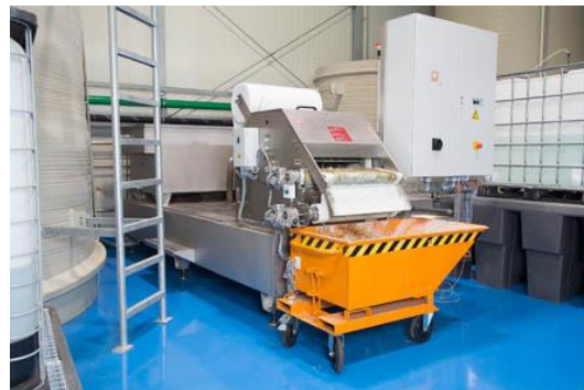
Bild Nr. 09-08 MK_RU-Vlies.jpg. Die Vorfilterstation UF 700 ist ein hydrostatisch arbeitender Schrägbettfilter mit einem 4000 Liter großen Edelstahl-Auffangbehälter. Der abgeschiedene Filtrationskuchen kann über einen kippbaren Schlammwagen bequem ausgebracht werden.
