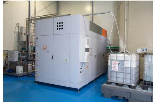
Bild Nr. 09-02 MK_RU-ET1500.jpg. Die energieeffiziente vollautomatische Verdampferanlage ET 1500 von MKR Metzger kann pro Stunde 1500 Liter Prozesswasser verarbeiten.
