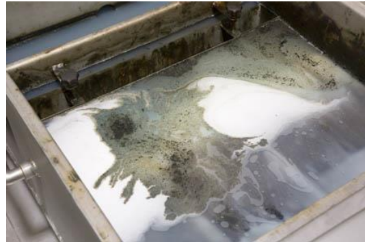
Bild Nr. 09-06 MK_RU-OelAb-Schmutz.jpg. Der Fremdölabscheider TB 800 funktioniert nach dem Koaleszenzprinzip und trennt Prozessmedien von Fremdölen.
