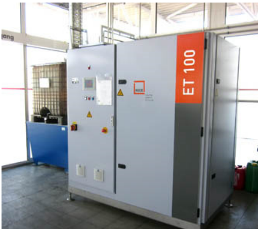
Bild Nr. 03-01 MK_ET100.jpg Nach Inbetriebnahme eines Verdampfers ET 100 von MKR Metzger hat ein Metallverarbeiter seine Entsorgungskosten um rund 90 % gesenkt.
