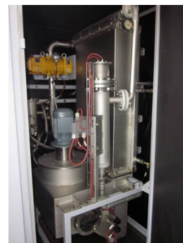
Bild Nr. 03-04 MK_WarmeZone.jpg Der Verdampfer arbeitet mit einer Prozesswasserleistung von 100 l/h. Für die Verarbeitung von 1000 Litern verbraucht der energieeffiziente ET 100 von MKR Metzger maximale 60 kW/h.
