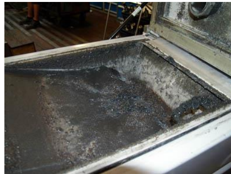
Bild Nr. 06-04 MK_KP-Bandfilter.jpg. Die abgepumpte Flüssigkeit durchläuft einen Vakuum-Bandfilter, der Feststoffe, Partikel und Späne wirkungsvoll herausfiltert.
