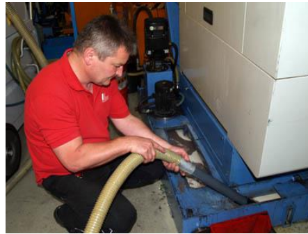
Bild Nr. 06-02 MK_KP-.jpg. Einfaches Abpumpen mit dem Hochleistungsaug- und Filterwagen SF500 von MKR Metzger.
