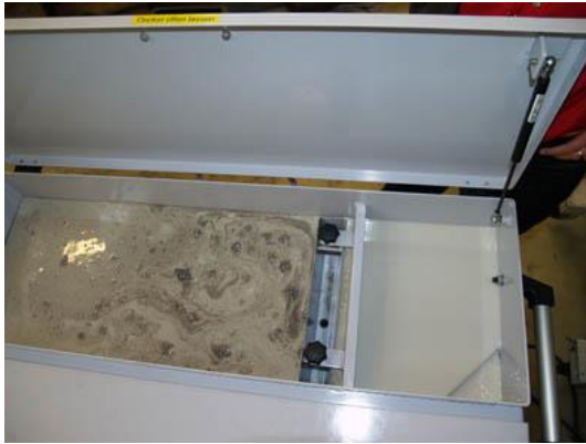
Bild Nr. 06-07 MK_KP-Fremdöl.jpg. Wie neu: Durch das Koaleszenzverfahren wirkungsvoll aufbereiteter KSS (re.).
