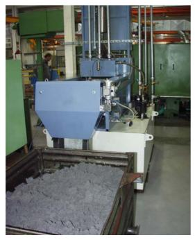
Foto 4 (030207-12-flender.jpg) Sieht aus wie eine Mondlandschaft: der getrocknete Schleifschlamm, wie er vom Vakuum-Bandfilter-Gerät ausgeworfen wird.
