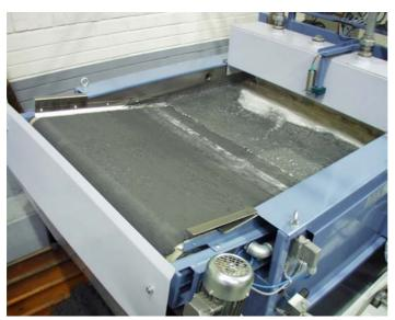
Foto 3 (030207-02-flender.jpg) Vom Filterband gelangt der trockene Schleifschlamm direkt in einen transportablen Auffangbehälter.
