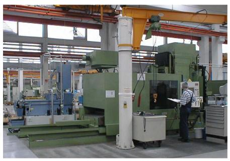
Foto 5 (030207-15-MKR-H11-2.jpg) Die Lösung bei Flender: Nach dem Konzept der dezentralen Versorgung reinigt immer ein Vakuum-Bandfilter-Gerät den KSS von zwei oder drei Schleif-Maschinen.
