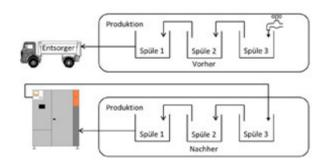
Vorher: hohe Kosten durch Entsorgung. Nachher: Die Spülwässer werden nun abwasserfrei im Kreislauf gefahren, nur die konzentrierten Öl und Schmutzrückstände fallen noch zur Entsorgung an. Gleiches gilt für die Reinigungsbäder.
